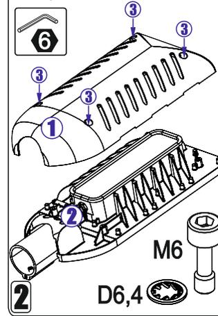
1. Установите светильник 1 на консоль 2 (трубу Ø48мм) до упора (предварительно выверните два болта 3 М10) и заведите питающий провод 4 внутрь;
