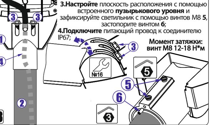
Момент затяжки: ВИНТ М8 12-18 Н\*М
